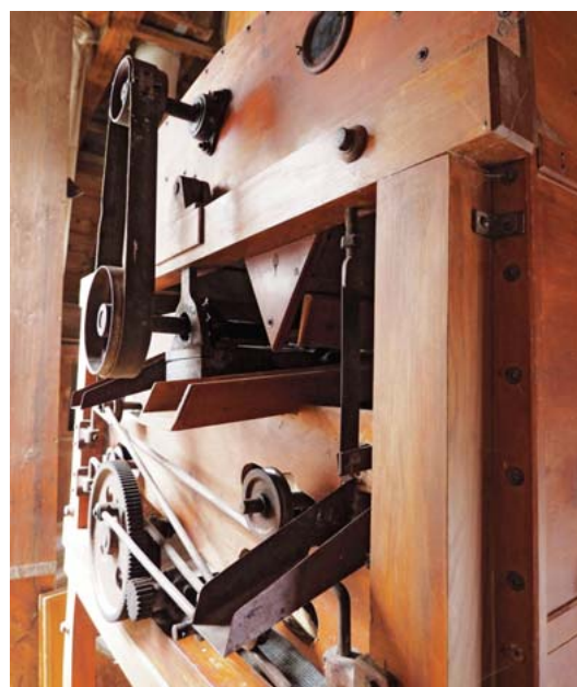
Abb. 22 (li.): Steingang und Walzenstuhl der Hypolzmühle: Hier findet der eigentliche Mahlvorgang statt; Abb. 23 (o.): Aspirateur in der Hypolzmühle: Die Vorrichtung besorgt eine erste Reinigung des Getreides
