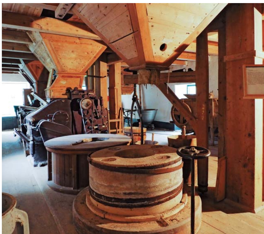
Abb. 22 (li.): Steingang und Walzenstuhl der Hypolzmühle: Hier findet der eigentliche Mahlvorgang statt; Abb. 23 (o.): Aspirateur in der Hypolzmühle: Die Vorrichtung besorgt eine erste Reinigung des Getreides
