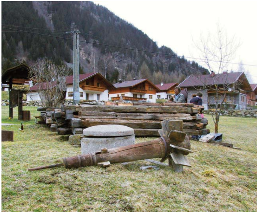
Abb.48 (li.): Abgerissene Mühle in Stampfen, Gemeinde Mörttschach, in Kärnten. Sehr gut sichtbar ist der Floder (in Kärnten Stock oder Mühlstock genannt) der Mühle; Abb. 49 (re.): Mühseliger Transport des neuen Floders zur Baustelle der Bocksbergmühle im Salzburger Gasteinertal durch Mitglieder des Kulturvereins „Ladislaus“.
