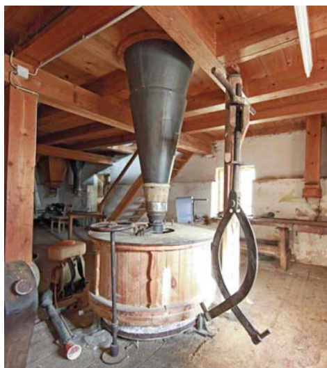
Abb. 19 (li.): Mahlgang mit Steinkran in der Marktmühle in Groß Gerungs im Waldviertel (Zwettler Str. 78); Abb. 20 (re.): Ansicht der Marktmühle von Südwesten.
