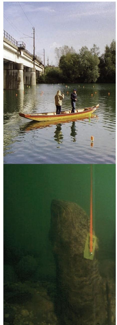
Abb. 17: Vermessungen der Pfeiler einer k.u.k. Eisenbahnbrücke von 1858 in der Enns im Jahr 1999
