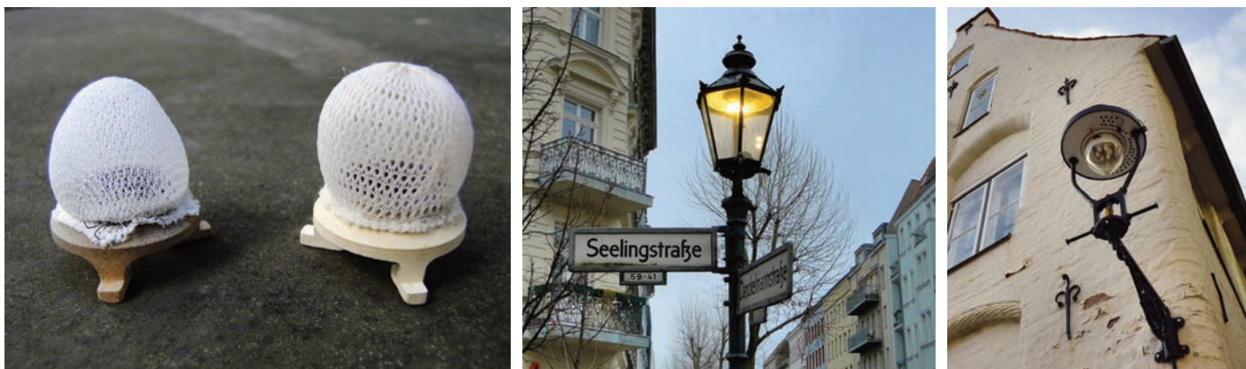
Abb. 77 (li.): Gasglühkörper Ring 1562 für Straßenbeleuchtung der Firmen Indal (links) und Petromax (rechts); Abb. 78 (m.): Die wohl berühmteste Gaslaterne der Welt, „Lili Marleen“ machte sie unsterblich: Die 1892 von den städtischen Berliner Gaswerken entworfene Berliner Modellleuchte, hier ein Foto aus Berlin-Charlottenburg. Sie wird wegen ihres Zierrats auch fälschlicherweise als „Schinkellaterne“ bezeichnet, doch der große Architekt und Stadtplaner Karl Friedrich Schinkel war bereits 1841 verstorben und hatte mit diesem Laterne-Modell nichts zu tun. Etwa 1.250 mit Gas betriebene Laternen sind derzeit in Berlin anzutreffen; Abb. 79 (re.): Sechsstämmige Gaslaterne mit gusseisernem Wandausleger, montiert an einem der zahlreichen historischen Giebelhäuser in der Altstadt von Lübeck.
