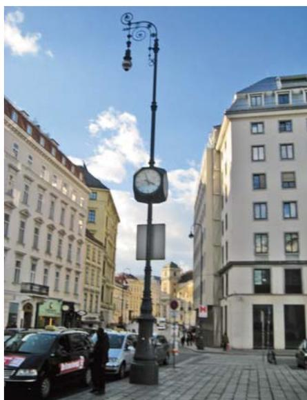
Abb. 77: Rekonstruierter Bogenlampenmast mit Schneckenausleger („Bischofsstab“) am Platz Am Hof im 1. Bezirk, auf dem eine moderne Würfeluhr montiert wurde
