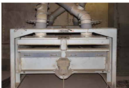
Abb. 26 (li.o.): Sackrutsche, Abb. 27 (li.u.): "Aspirator": Auf Rüttelsieben werden im Luftstrom Käferleichen aus dem Getreide entfernt; Abb. 28 (re.o.): Blick vom Dach eines Speichers auf das einzige realisierte Hafenbecken, angrenzend sollten zwei weitere errichtet werden; Abb. 29 (re.u.): Im Inneren des Speichers im Vordergrund, der zur Tarnung in Hausform gebaut wurde, blieb vieles im Originalzustand.
