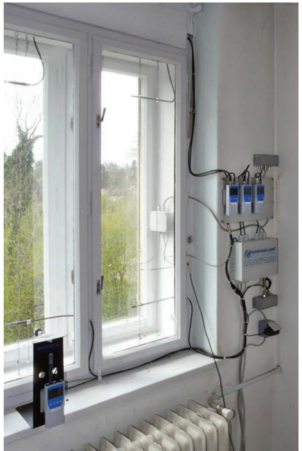
Abb. 40: DMA Kastenfenster mit Messeinrichtung - Schönbrunngrasse Original Sensoren
