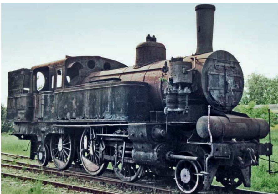
Abb. 23: Die Dampflokomotive 29.22 der kkStB von 1912 wartet auf eine Aufarbeitung. Viele der heute betriebsfähigen Dampflokomotiven befanden sich in einem ähnlich schlechten Zustand, bevor die Mitglieder des 1. öSEK sie mit einem Aufwand von durchschnittlich 8.000 Arbeitsstunden renoviert haben.
