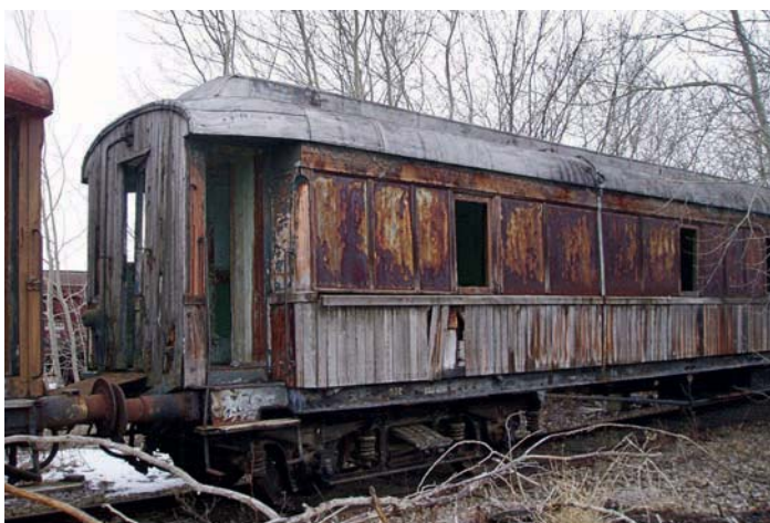
Abb. 22: Personenwagen mit Holzkastenaufbauten sind heute in Österreich eine Rarität. Der einzig erhalten gebliebene Schlafwagen aus der Zeit um 1900 ist schon sehr stark verfallen.
