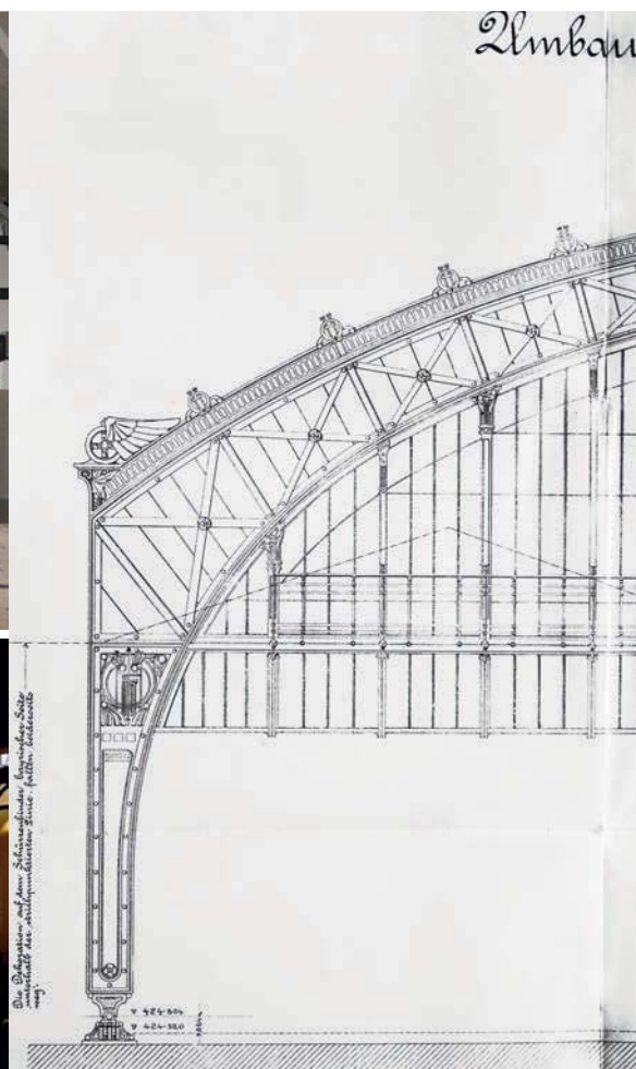
Abb 48 : Planzeichnung eines Schürzenbinders der Bogenhalle mit den auf österreichischer Seite angebrachten dekorativen Elementen (Ausschnitt)
