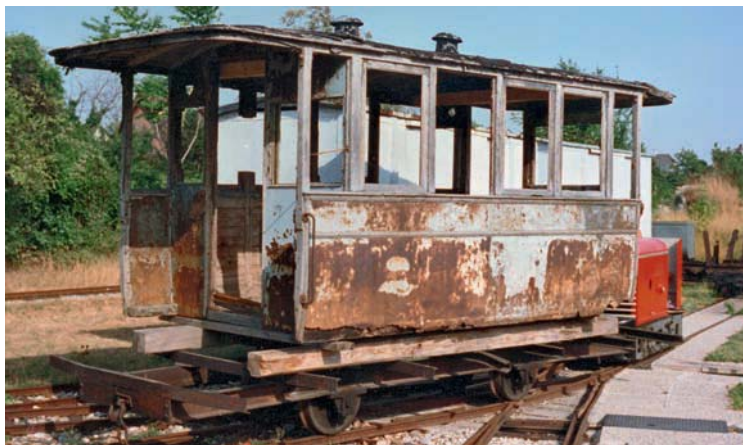
Abb. 39: Der 14er-Wagenkasten auf einem von Stern & Hafferl beschafften, aber keinesfalls passenden Untergestell. Heute befindet sich der Kasten in Rekonstruktion (Foto: 1992)
