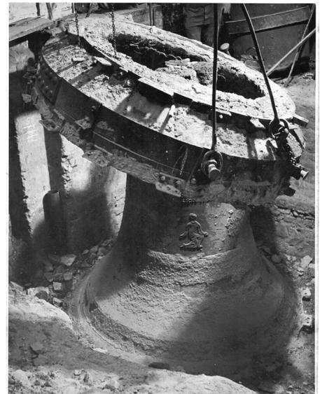
Abb. 36: Die größte Glocke des elfstimmigen Geläutes für den Wiener Stephansdom wird nach dem Guss aus der Form befreit.
