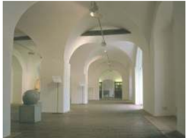
Abbildung 20a: Karthause Mauerbach bei Wien, Lapidarium. Temperierung der nicht unterkellerten Räume des Lapidariums mit ehemals großer Feuchteproblematik in Gelände und Mauerwerk, die seit dem ständigen Betrieb der Sockelheizrohre zum Stillstand gekommen ist. Aufnahme 2002, Autorin.
